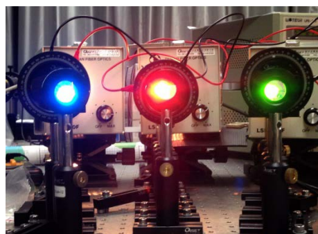
圖六、液晶控制光穿透率的顯示技術實驗
